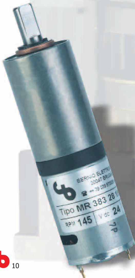
Lunghezza "L" del motoriduttore in funzione della riduzione e del numero di giri in uscita con il motore standard 383 8 W resi, 9000 giri a vuoto, 12/24 Vdc. Corrente di spunto 2,1 A.
